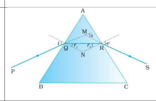
ऊपर दिया गया चित्र एक त्रिभुजाकार प्रिज्म ABC से होकर प्रकाश के गुजरने को दर्शाता है। पहले फलक AB पर आपतन और अपवर्तन कोण i और  $r_1$  हैं, जबिक दूसरे फलक AC पर आपतन कोण (कांच से हवा तक)  $r_2$  और अपवर्तन या निर्गमन कोण e है। निर्गत किरण RS और आपतित किरण PQ की दिशा के बीच के कोण को विचलन कोण  $\delta$  कहते हैं।
